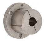
As buchas Martin Split Taper (MST®) oferecem uma flange sólida com uma divisão dupla através da conicidade e são chavetadas no eixo e no cubo para auxiliar na instalação "cega". O cone e a chaveta do cubo fornecem fixação no eixo, resultando em maior capacidade de suportar torque e operações com reversões.
