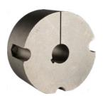
As buchas cônicas (TB) têm uma única divisão na conicidade enquanto os parafusos são usados para apertá-lo no eixo. Não há danos ao eixo após a remoção e o projeto de montagem embutida, além de contar com substituição mais rápida, facilita para instalações com espaço físico limitado.
