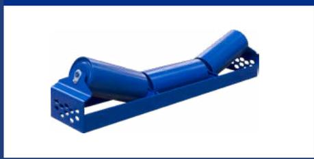
Os Roletes de Canal Inserido são montados por baixo e dentro da estrutura do transportador ou montados verticalmente e parafusados horizontalmente. O design de baixo perfil é frequentemente usado em equipamentos móveis onde a redução de altura é muito importante. Esses roletes estão disponíveis em aço ou como Roletes de impacto
