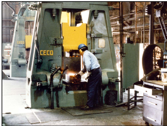
Um dos diversos martelos capazes de produzir peças forjadas de até 23 kgs.
