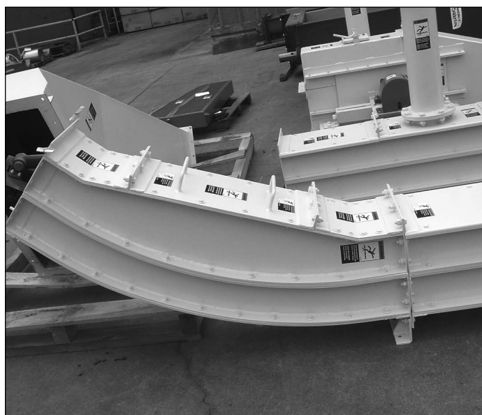
Transportador de Corrente MLP com espaço inferior no cotovelo inferior para acomodar o lado frouxo da corrente
