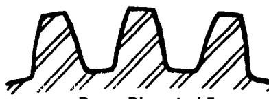
Passo Diametral 5 Passo Circular de 0.6283"
